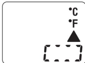
1. El instrumento ha sido expuesto a variaciones de temperatura severas y necesita tiempo para aclimatarse al entorno actual.
