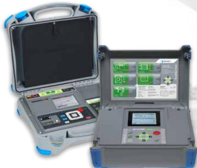
La pantalla LCD de gran tamaño permite la presentación de la gráfica R(t) en tiempo real. Los resultados se pueden almacenar y descargar a un ordenador a través de una conexión USB o RS232 con la ayuda del software HVLink PRO. El instrumento de alta calidad, los cables de prueba apantallados y los accesorios incluidos en el equipo estándar permiten realizar las comprobaciones del aislamiento de un modo rápido, sencillo y eficaz.
